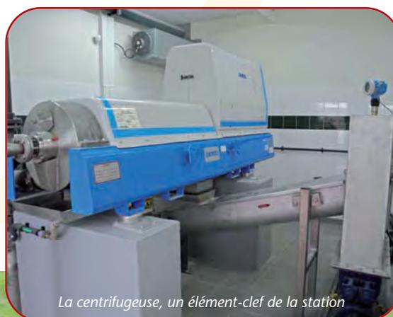
La centrifugeuse, un élément-clé de la station
