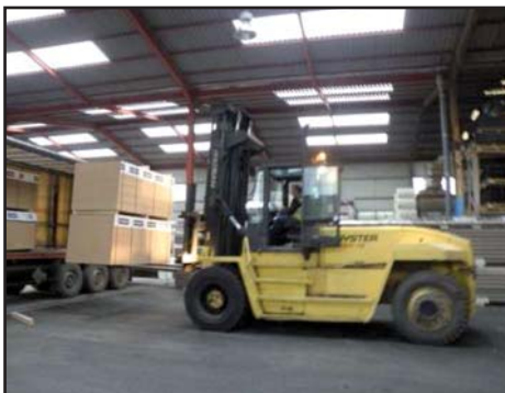
Déchargement avec un chariot élévateur capable de soulever 18 tonnes.
