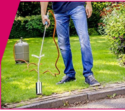
Le désherbage thermique : une alternative aux produits chimiques pour éliminer les mauvaises herbes.
